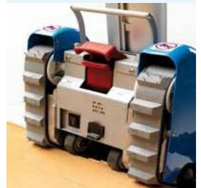
Sistem de blocare dublu,electric și mecanic, al conexiunii barei de direcție la carcasa motorului
